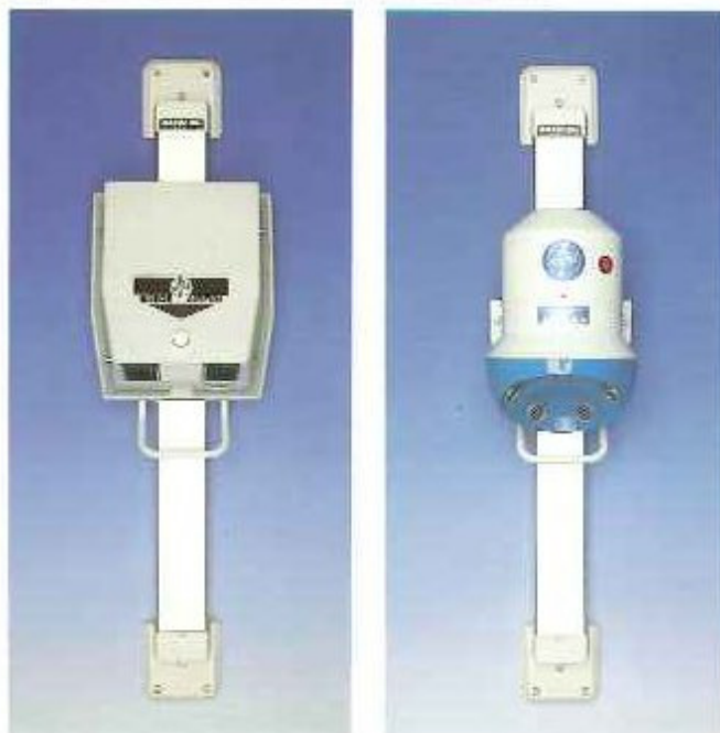
Haardroger model PROGRESS met druktijdschakelaar type 1206. Spanning: 220 V - 50 Hz, Vermogen: 1200 W. Mantel in plaatstaal. Kleur: gebroken wit met een lichtgrijze kunststof droogkap. Opties: hoogteregelaar, muntautomaat.
