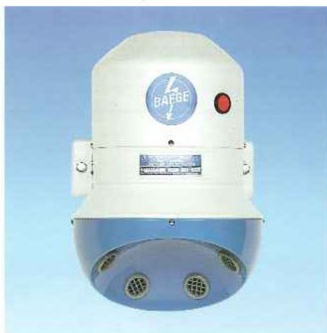
Haardroger model PROGRESS met druktijdschakelaar type 1206. Spanning: 220 V - 50 Hz, Vermogen: 1200 W. Mantel in plaatstaal. Kleur: gebroken wit met een lichtgrijze kunststof droogkap. Opties: hoogteregelaar, muntautomaat.
